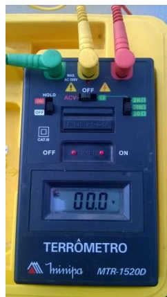
Figura 01 – Terrômetro Minipa MTR 1520D.
