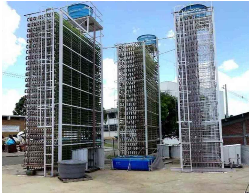
Figure 2. Compact conduits-array Photobioreactor (PBR). Source: Núcleo de Pesquisa e Desenvolvimento em Energia Autossustentável NPDEAS - UFPR (2016)
